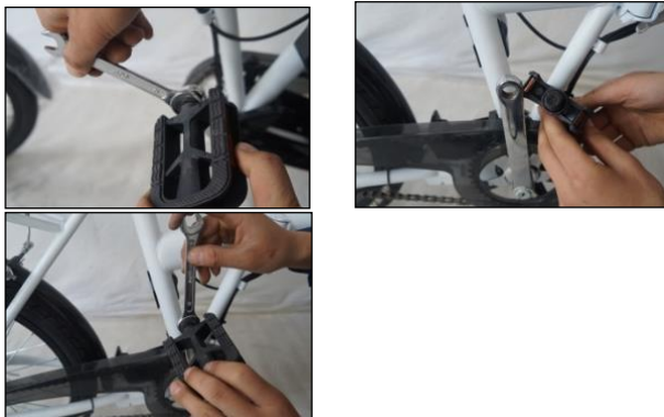
Figura 4 – Montaggio dei pedali.
