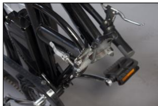
Figura 2 – Apertura e fissaggio del telaio.
