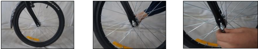
Figura 3 – Montaggio della ruota anteriore.
